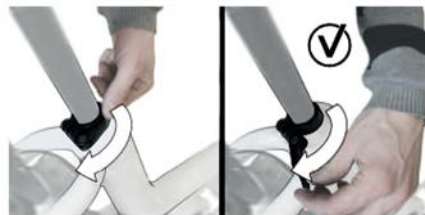
Billede 6: Åbning af sadelpinden quick release
