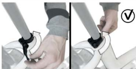
Billede 8: Lukning af sadelpinden hurtigudløser
